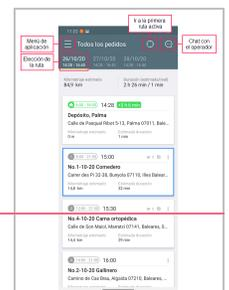
**Modo de rastreador.** Activar y desactivar el rastreador en la aplicación móvil. Para utilizar las funciones del rastreador, se necesita seleccionar el tipo de dispositivo **WiaTag** e indicar el **ID único** (valor personalizado) en las [propiedades de unidad](#) en el sistema de seguimiento. Solo después en los ajustes de la aplicación se hace disponible el interruptor correspondiente.
