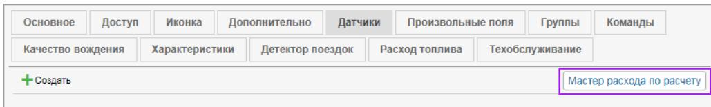
При открытии мастера расхода по расчету системой производится поиск уже созданных датчиков работы двигателя (зажигания, относительных и абсолютных моточасов) и датчиков полезной работы двигателя, а также проверяются значения предыдущих настроек.
