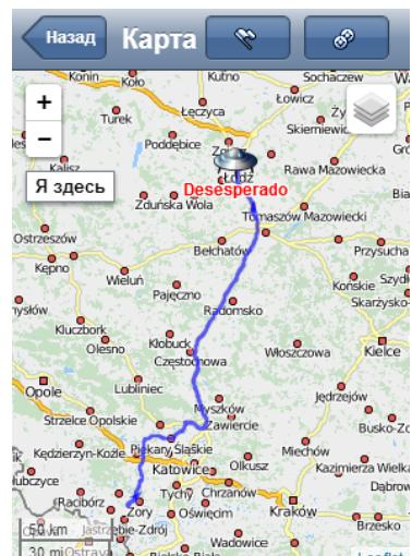
Кликнув по любой точке трека, можно получить подробную информацию об этом сообщении: время, скорость, адрес, количество спутников. При клике по объекту доступны две опции: *Удалить трек* и *Информация*. Первая предназначена для удаления треков данного объекта с карты, вторая – для вызова всплывающего окна с последней информацией об объекте.
