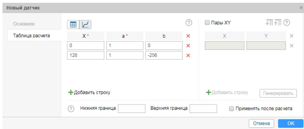
Полученный результат создания таблицы преобразования можно оценить на графике расчета.
