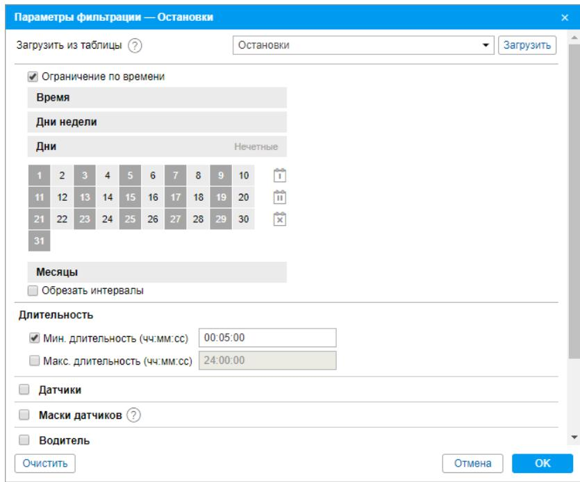
Если фильтрация интервалов уже была настроена для таблицы и она подходит для отображения графических элементов на карте, то можно загрузить настройки, примененные в ней. Для этого выберите необходимую таблицу в выпадающем списке «Загрузить из таблицы» и нажмите «Загрузить».
