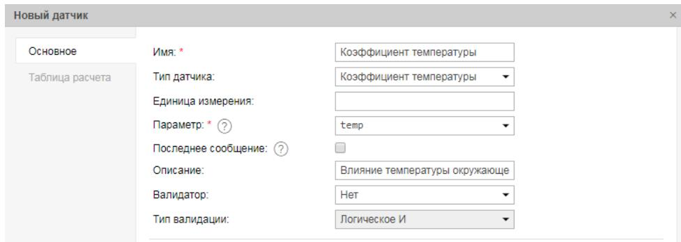
Далее переходим на вкладку «[Таблица расчета](#)» и при помощи [мастера](#) вводим значения — коэффициент для максимальной температуры и коэффициент для минимальной температуры. Но для этого нужно произвести некоторую предварительную подготовку:
