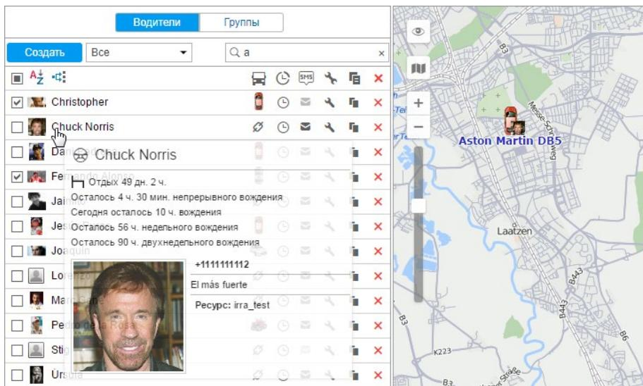
DDD-файлы, полученные с тахографа, содержат сведения об активности водителя. Данные файлы могут быть выгружены автоматически (при соответствующих настройках оборудования) или вручную (посредством приложения «[TachoManager](#)»). Полученные сведения об активности водителя помогают проследить, выполняет ли водитель нормы ЕСТР. Отображаются данные сведения во всплывающей подсказке к каждому водителю и включают в себя следующую информацию:
