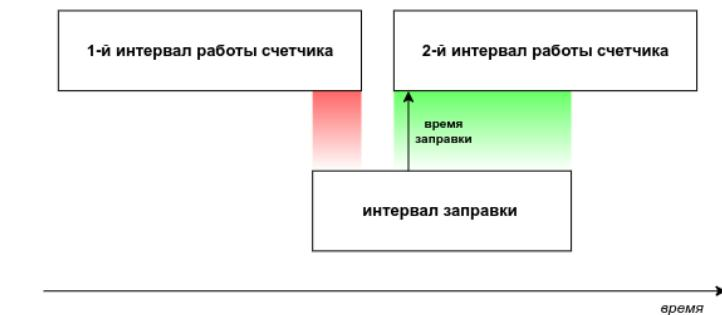
Если такого совпадения не было, то алгоритм ищет пересечения всего интервала заправки объекта, получившего топливо, с интервалами работы счетчика объекта, его раздававшего, и выбирает ближайший из них (см. рисунок).
